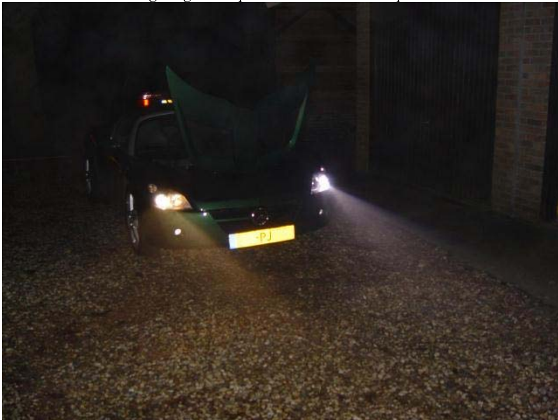
Foto 13. Verschil Halogeen gloeilamp versus Xenon HID lamp.
