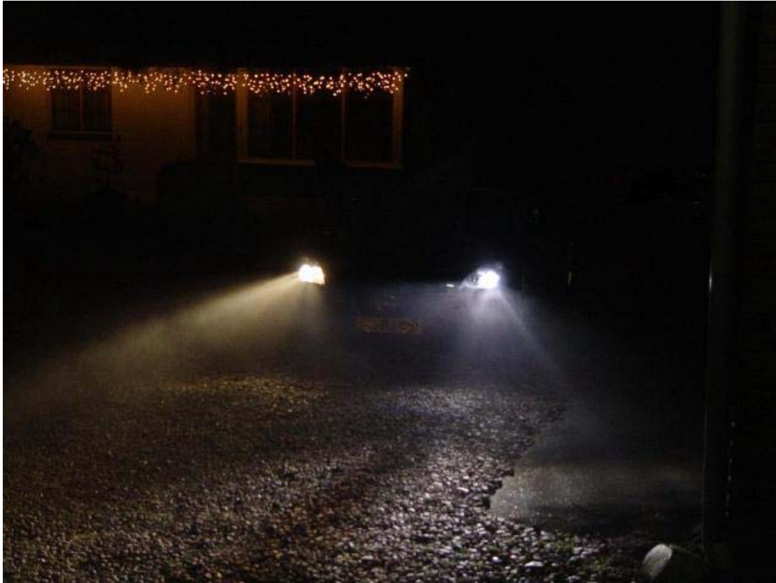
Foto 12. Verschil Halogeen gloeilamp versus Xenon HID lamp.
