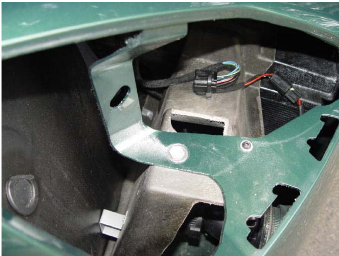
Foto 9. Ruimte genoeg voor plaatsing van de ballast.
