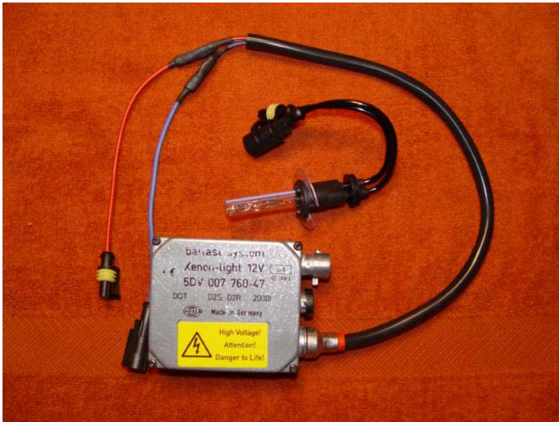
Foto 1. Xenon HID lamp met ballast.
