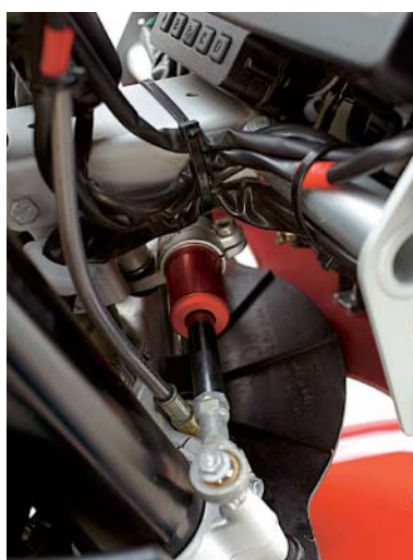
De instelbare stuurdemper stabiliseert de Aprilia, wat het rijgedrag ten goede komt.
