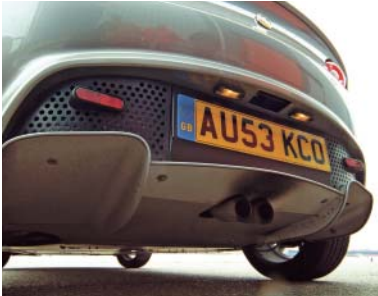
De gladde onderkant zorgt voor een optimale windgeleiding.
